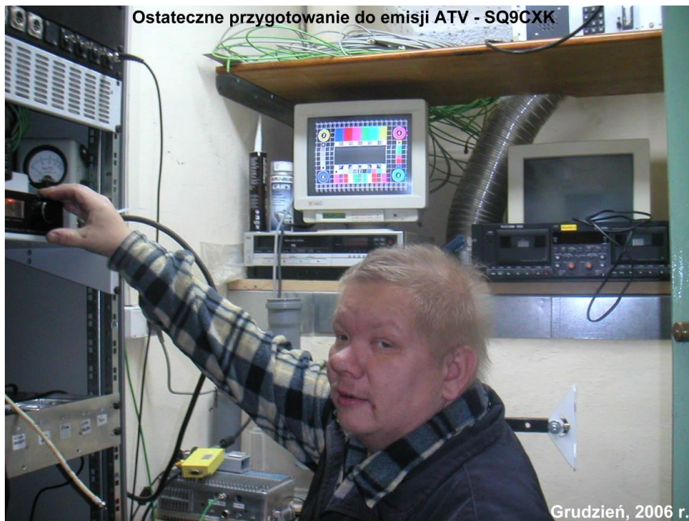
Piotr SQ9CXX testujący przemiennik ATV
